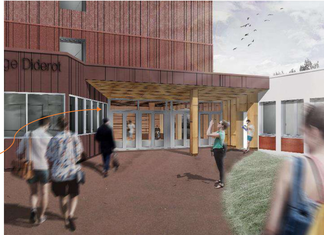
Réemploi partiel du bardage Prodema en habillage du porche
